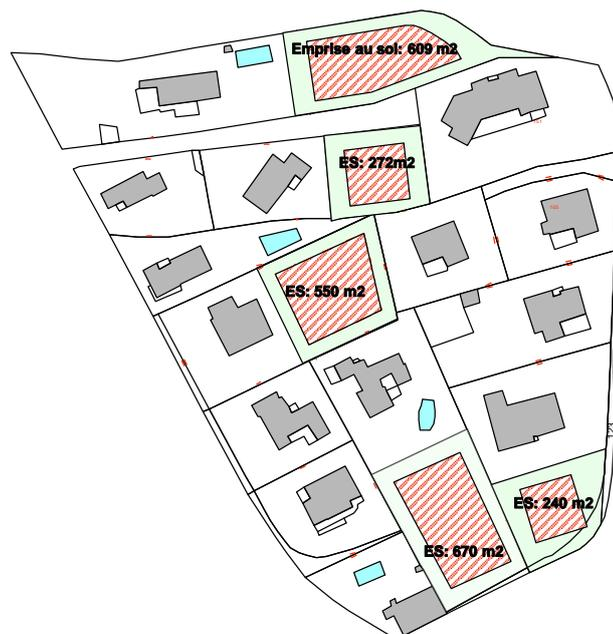
Etape n°3 : Simulation des emprises au sol obtenues avec le coefficient
